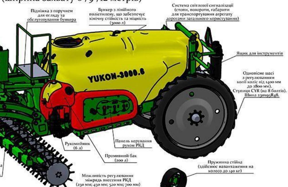
**Ін'єкційне колесо для внесення РКД з нержавіючої сталі (тиск на стійку 140 кг).**
